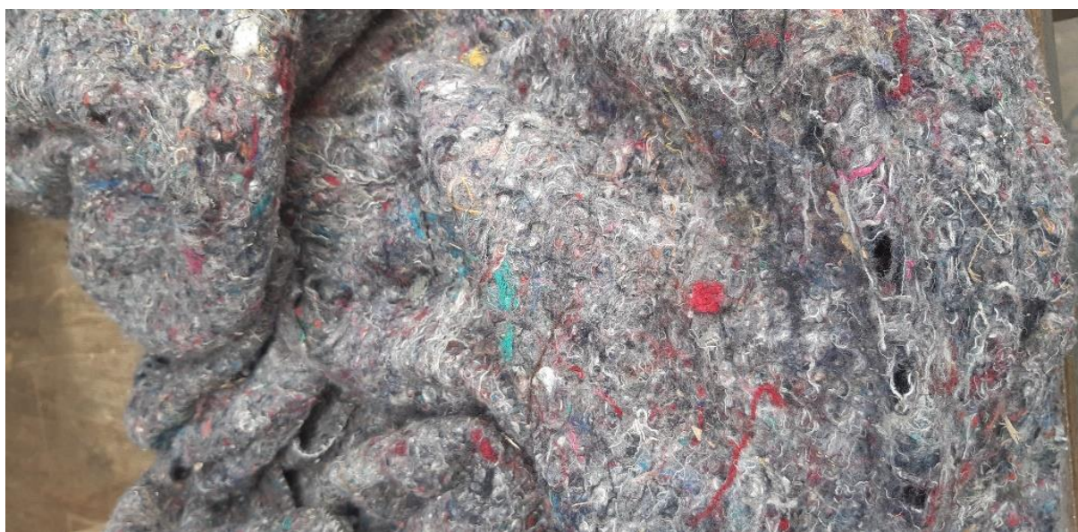
Cobertor que resulta da prensa de fibras naturais e sintéticas (foto: Yuji Gushiken)
