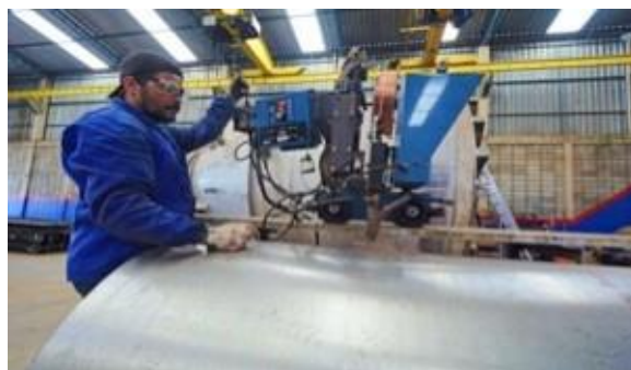
Figura 5 - Soldagem na horizontal. Fonte empresa pesquisada.
