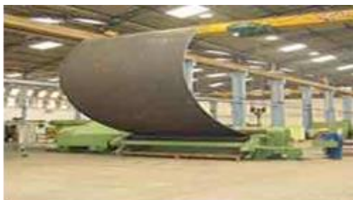
Figura 3 – Processo de calandragem. Fonte os autores.
