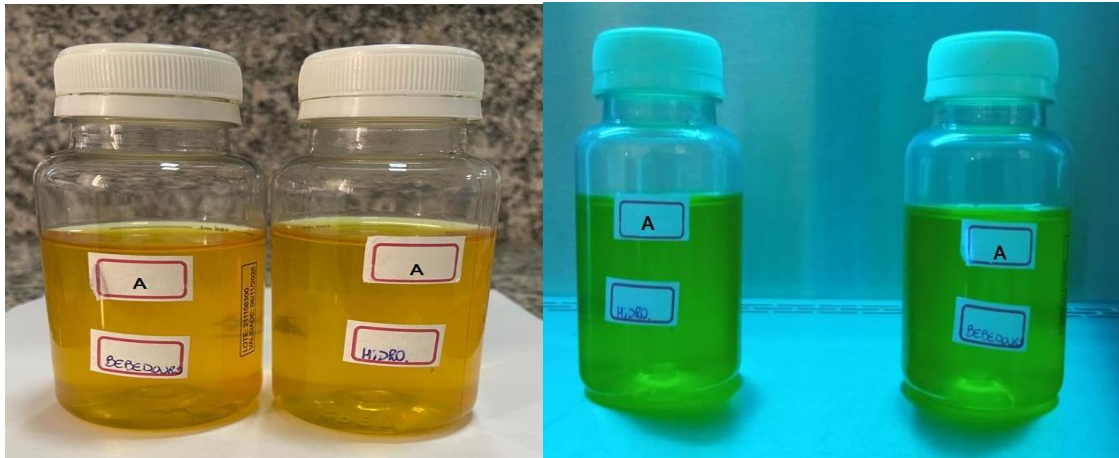
Figura 1. Presença de coliformes totais e de E.coli nas amostras de água da Instituição de Ensino Infantil “A”.
