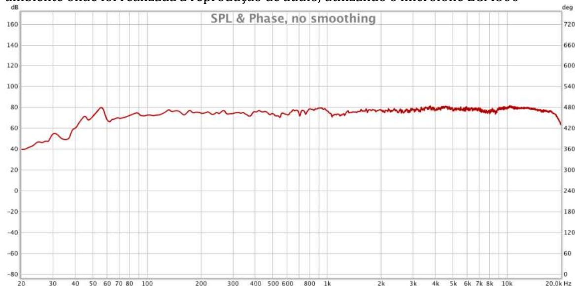
Figura 2 - Curva de resposta em função de frequência do monitor de referência dentro do ambiente onde foi realizada a reprodução de áudio, utilizando o microfone ECM800
