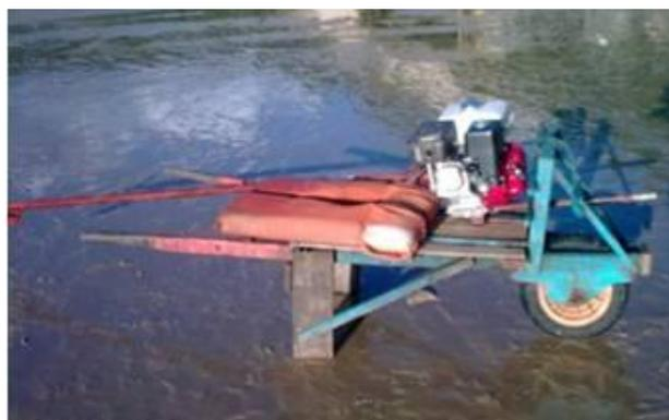
**Figura 6 – Carrinho artesanal em madeira utilizado para transporte do motor e outros equipamentos e utensílios**
