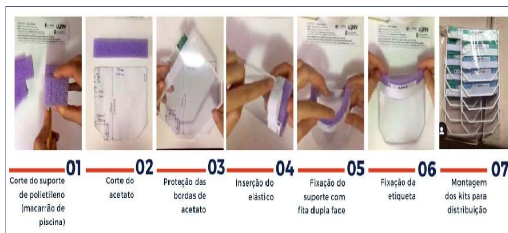
Figura 7: Etapas da produção do Protetor Facial para bebês
