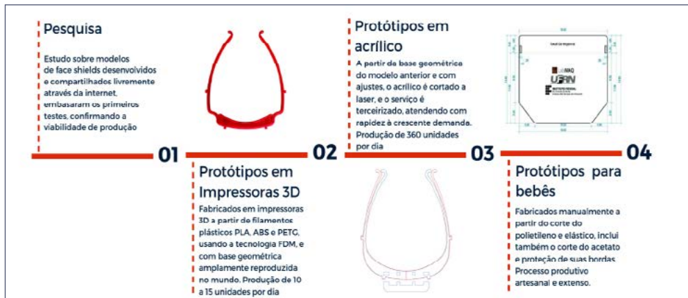
Figura 8: Etapas da pesquisa e produção dos tipos de Protetores Faciais
