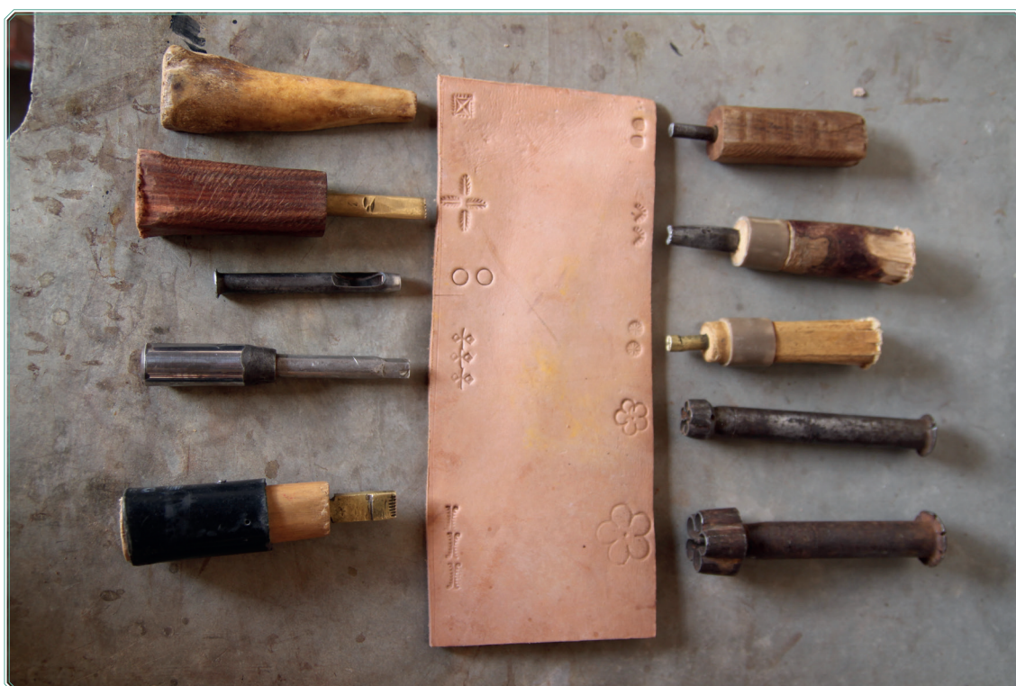
Figura 03 - Ferros de marcar couro utilizados no trabalho de ornamentação de selas, cintos e outros produtos fabricados por Erivaldo Batista de Araújo (Caicó).
