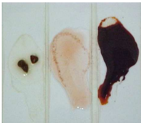
Figura 1. Reação para o ferro, utilizando-se tiocianato de amônio.
