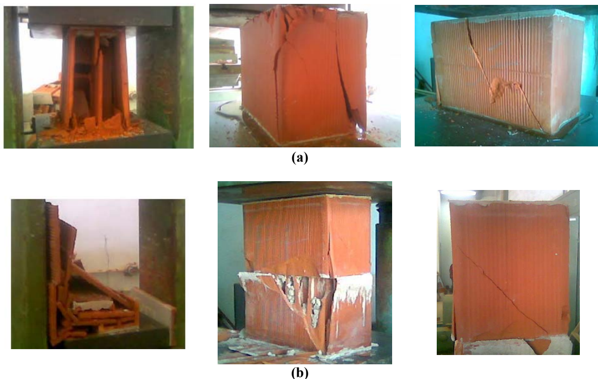
Figura 1 – Modos de ruptura experimentados pelos corpos-de-prova. (a) Unidades e (b) Prismas.
