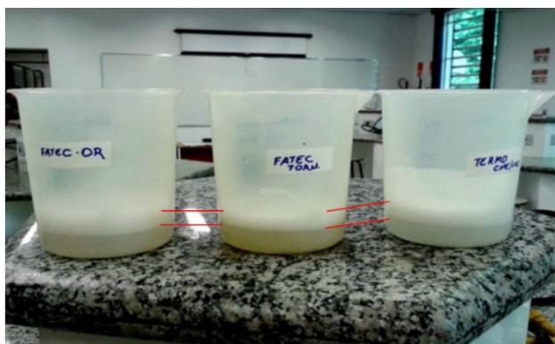
**Figura 7** – Formação de espuma em água de OR, água da torneira e água da termodesinfectora.
