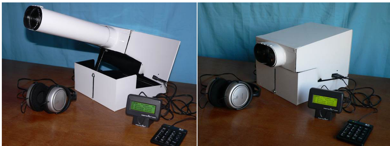
Figura 8 – Primeiro protótipo, construído em aço carbono, com um netbook embarcado. Fonte: Do próprio autor (2009).
