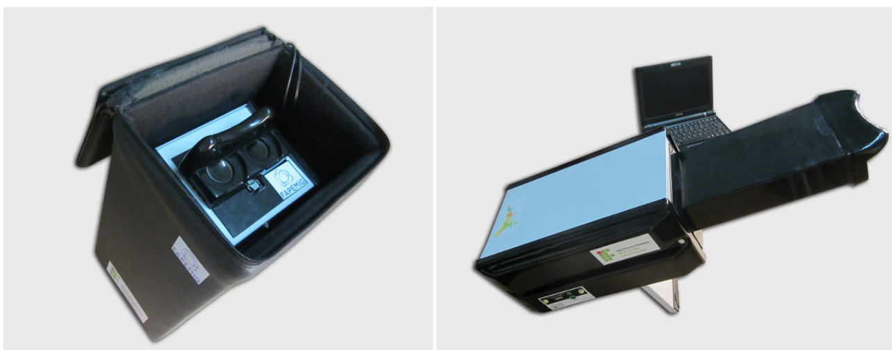
Figura 10 – Terceiro protótipo, construído em aço carbono e polímero, com sistema de controle externo. Fonte: Do próprio autor (2013).
