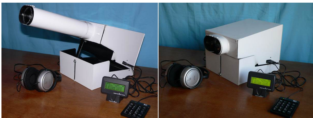
Figura 8 – Primeiro protótipo, construído em aço carbono, com um netbook embarcado. Fonte: Do próprio autor (2009).
