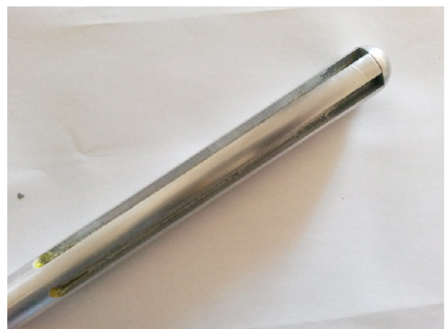
Figura 5 – Molde em alumínio para a confecção do cateter onde pode-se ver os chanfros para a colocação dos sensores. Fonte: Do próprio autor (2016).
