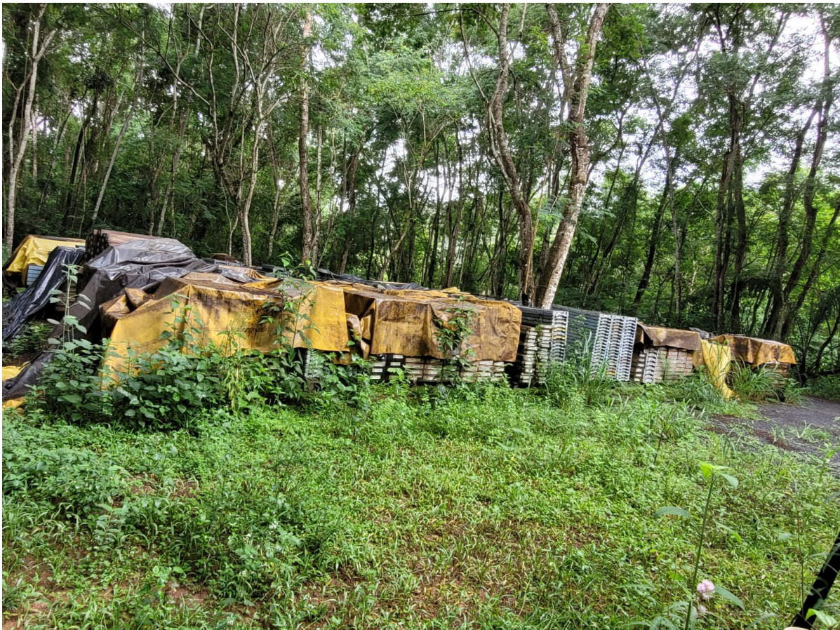
Imagem 04: Caixas de testemunho de sondagem expostas em céu aberto devido à falta de espaço em galpões
