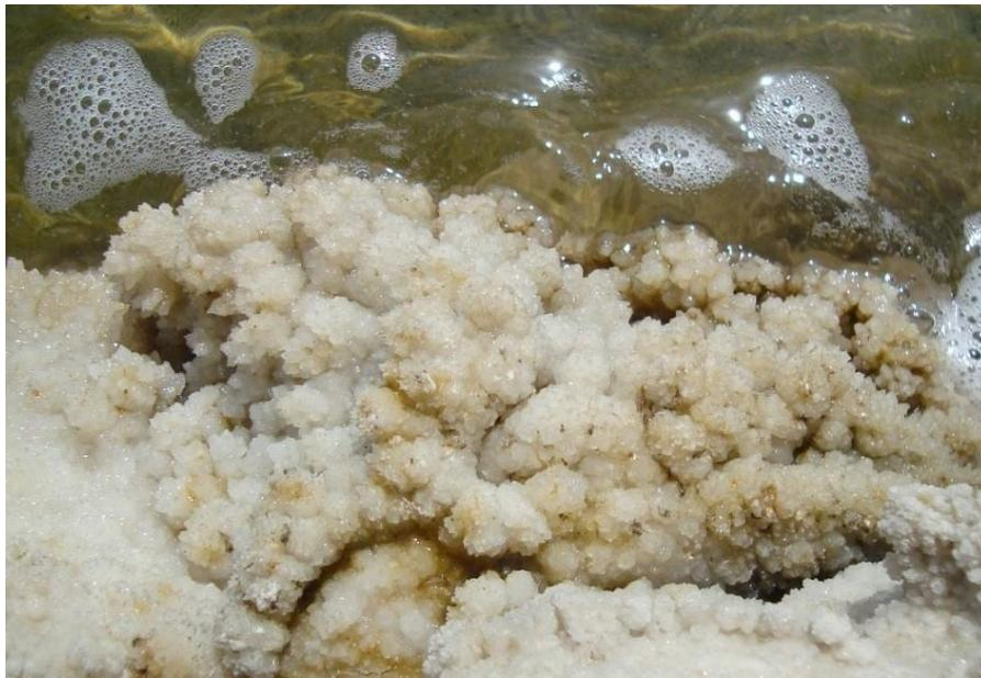
**Figura 03.** Cristais de gipsita ( $\text{CaSO}_4 \cdot 2\text{H}_2\text{O}$ ) formados nos evaporadores com salinidades de  $150$  e  $160 \text{ g.L}^{-1}$ .
