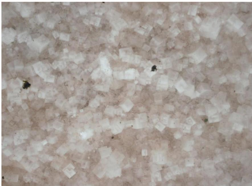
**Figura 04.** Tanque cristizador onde se deu a precipitação final dos cristais de halita (NaCl) a partir de 210 g.L<sup>-1</sup>.
