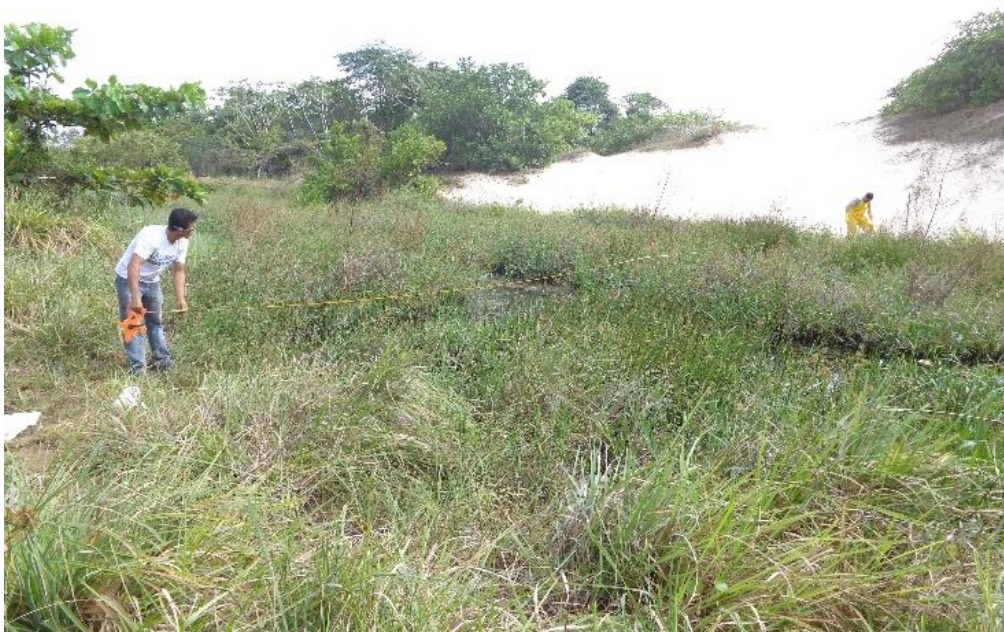
Figura 4: Medição da largura do rio Urucutuiua (ponto P03) para determinação da vazão. Fonte: Autores, 2014.
