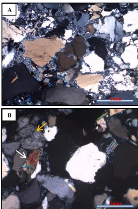
Figura 4 - Constituintes primários dos arenitos da Formação Iborepi: A) Grãos de quartzo monocristalino (PX); B) Feldspato microclínio fraturado e parcialmente alterado (seta laranja) e muscovita entre grãos (seta branca, PX).
