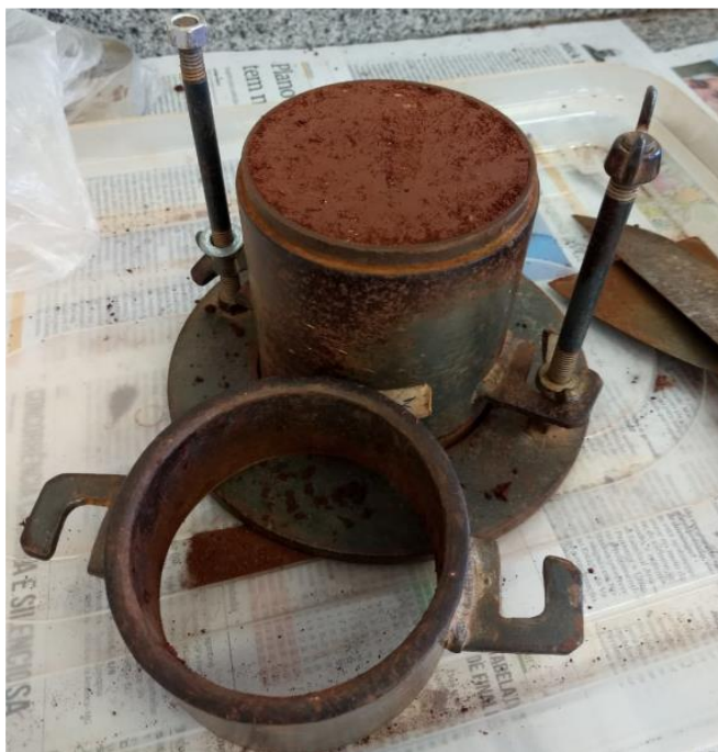
Figura 4 – Cilindro com o solo compactado para coleta dos dados de densidade. Fonte: Autor (2019).
