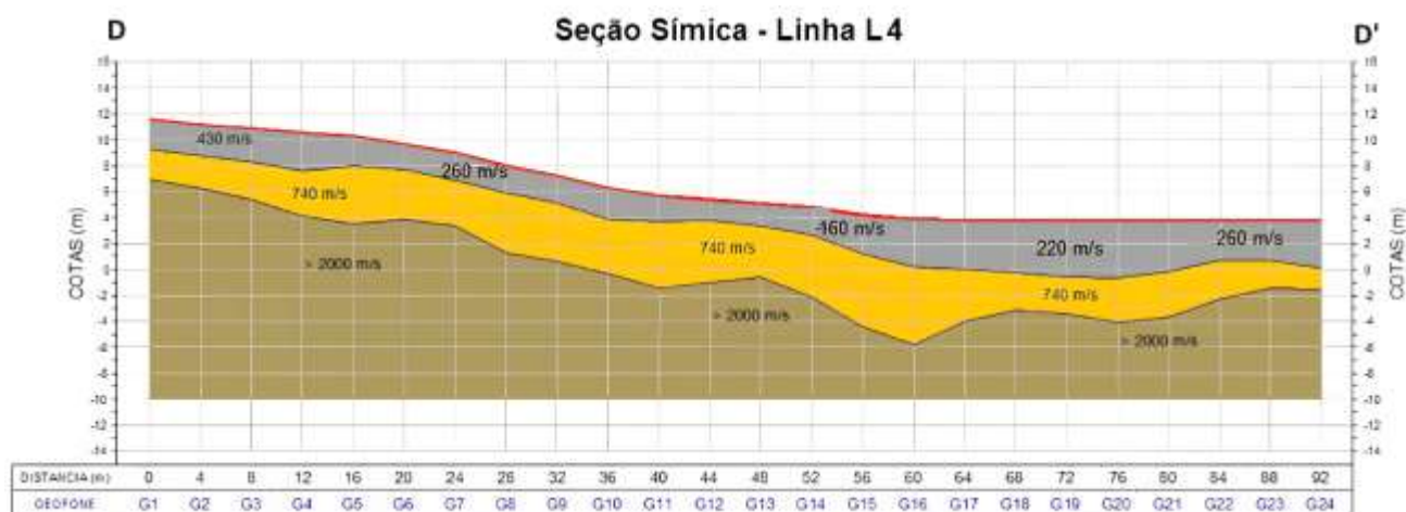
Figura 10 – Modelo sísmico inferido referente a linha, 4. Fonte: Autoria própria.
