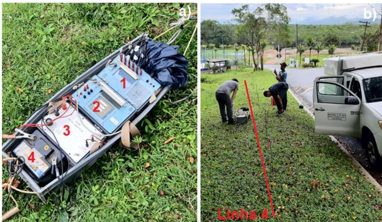
Figura 5 – a) Sistema Rho/IP utilizado no caminhamento elétrico, 1(receptor), 2(emissor), 3(conversor DC/DC), 4(bateria). b) Levantamento dos dados na Linha 4.
