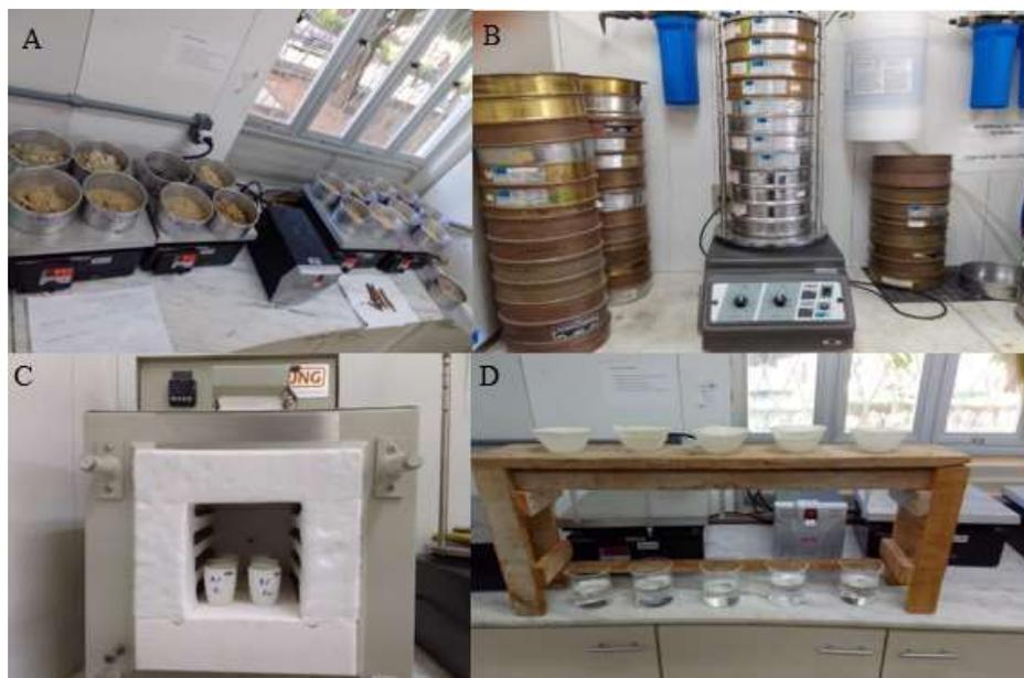
Figura 03 – Metodologia de laboratório. Amostras em secagem (A); Jogo de peneiras no aparelho ROT-UP (B); Amostras na mufla (C); Lavagem das amostras (D).
