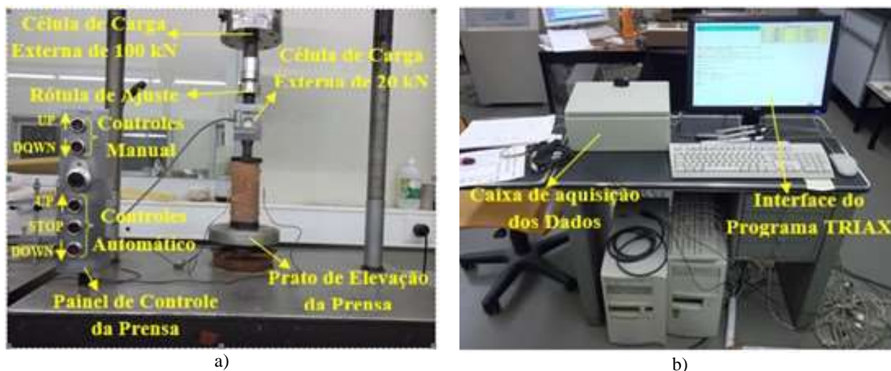
Figura 1 – a) Detalhes da moldagem. b) Sistema de aquisição de dados eletrônicos. Fonte: Autor (2013).
