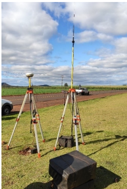
Figura 2 – Montagem do sistema GNSS Trimble RTK R4. Fonte: Autores (2025).
