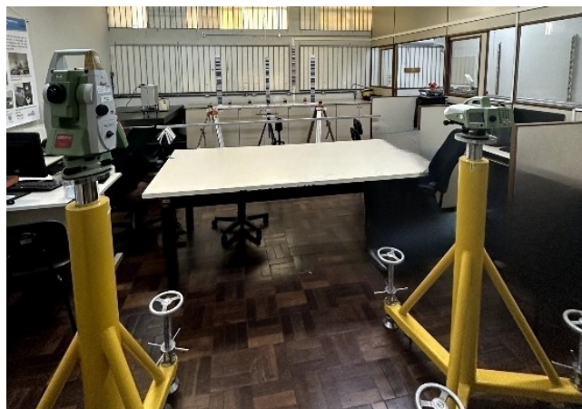
Figura 2 – ETR TS15 e Nivel DNA03 instalados sobre tripés industriais. Fonte: Autores (2024).
