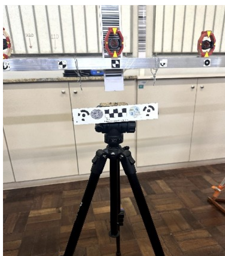
Figura 3 – Distribuição dos alvos fotogramétricos para pontos de controle e pontos objeto. Fonte: Autores (2024).
