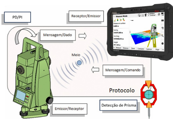
Figura 5 – Princípio da detecção automática de prismas em uma ETR.
