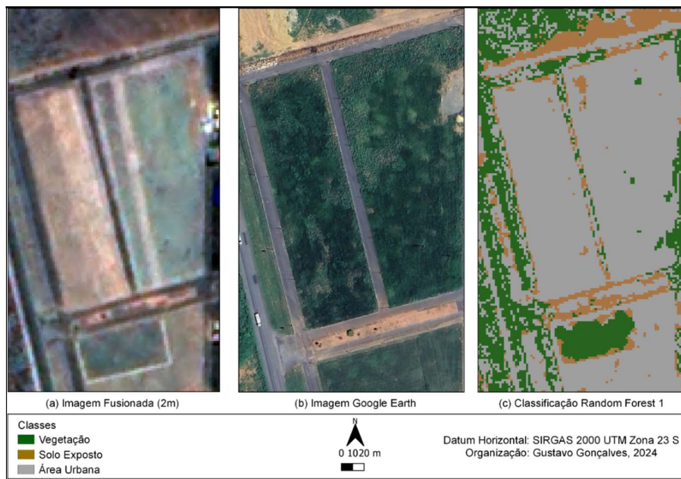
Figura 3 – Exemplo de classificação de imagem ilustrando confusão dos pixels de vegetação com área urbana. Fonte: Autores (2024).
