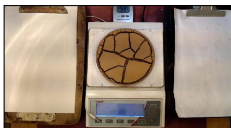
Figura 2 – Monitoramento do processo de formação e propagação de fissuras por ressecamento. Fonte: Autores (2024).
