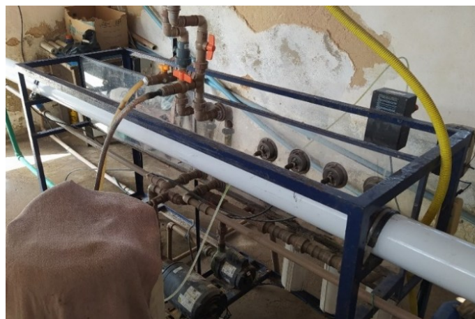
Figura 9 – Dessalinizador do Chafariz público de Bengalas (poço E). Fonte: Barbosa et al (2025).
