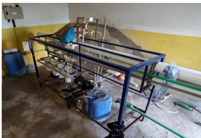
Figura 6 – Dessalinizador de Poço de Pau (Poço B). Fonte: Barbosa et al (2025).
