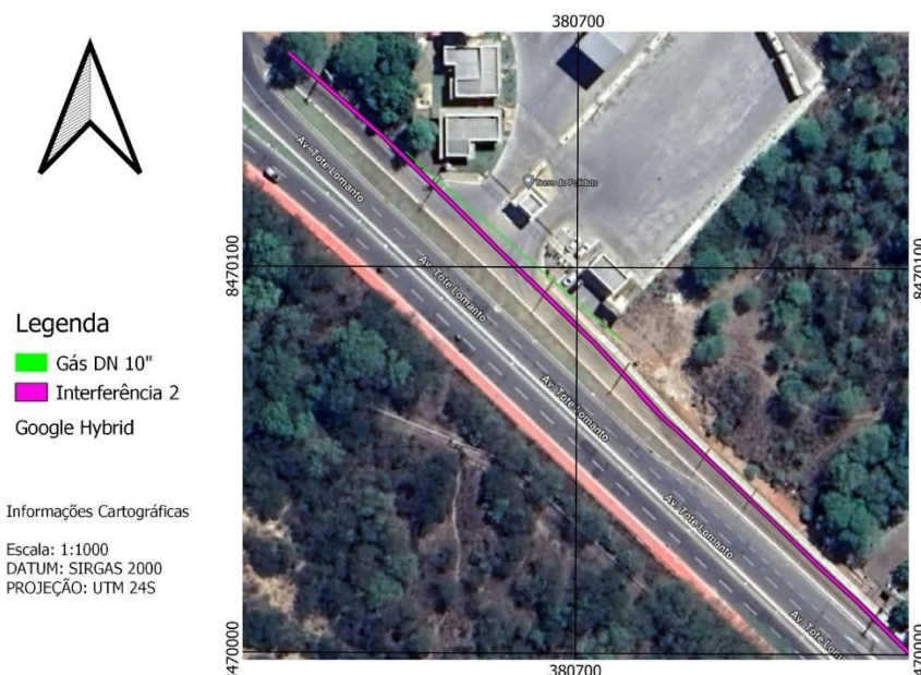
Figura 10 – Vista superior, localização de anomalia eletromagnética interferência 1 e 2, possível tubo de gás. Fonte: Autores (2024).
