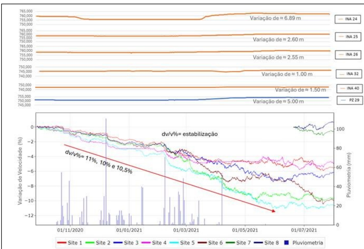
Figura 7 – Intervalo analisado no período de 01/10/2020 a 31/07/2021. A figura mostra a variação do nível d'água medida por medidores de nível d'água (INAs) e piezômetros, comparada com a variação da velocidade da onda S ( dv/v\% ) ao longo do tempo e a precipitação acumulada diária. A seção superior exibe os níveis d'água medidos por diferentes INAs (24, 25, 26, 32, 40) e pelo piezômetro PZ 29, com variações entre 1,0 m e 6,89 m, indicando mudanças no comportamento da saturação. A seção inferior mostra a variação percentual da velocidade da onda S ( dv/v\% ) em vários geofones (1 a 8) ao longo do tempo, correlacionando-a com a precipitação (barras azuis). A estabilização é observada após uma redução significativa de 10% a 11% na velocidade da onda S, relacionada ao aumento da umidade. A linha vermelha destaca uma redução de até 11% na velocidade.
