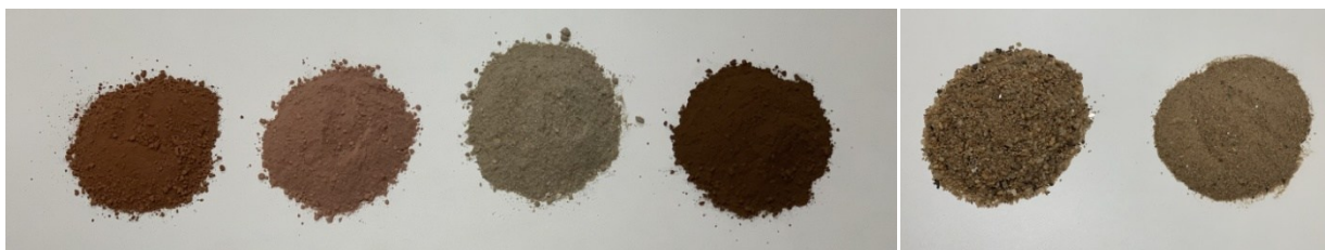
Figura 1 – Fotos dos materiais utilizados, sendo eles: Solo 1, Solo 2, Solo 3, Rejeito, Areia Grossa e Areia Natural. Fonte: Autores (2022).
