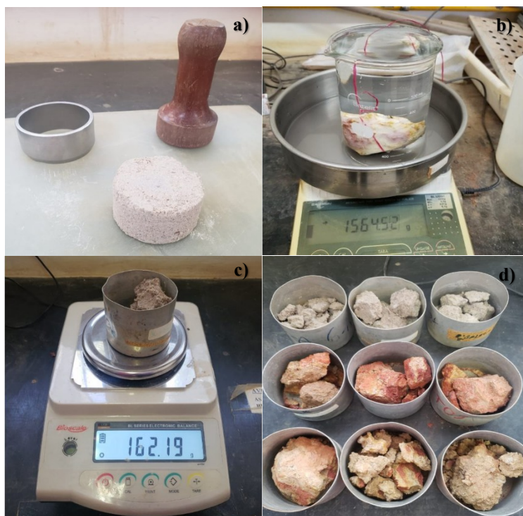
Figura 4 – Preparo do corpo de prova do ensaio de cisalhamento direto (a); e obtenção da umidade do solo antes do ensaio (b, c, d). Fonte: Elaborada pelos autores (2024).
