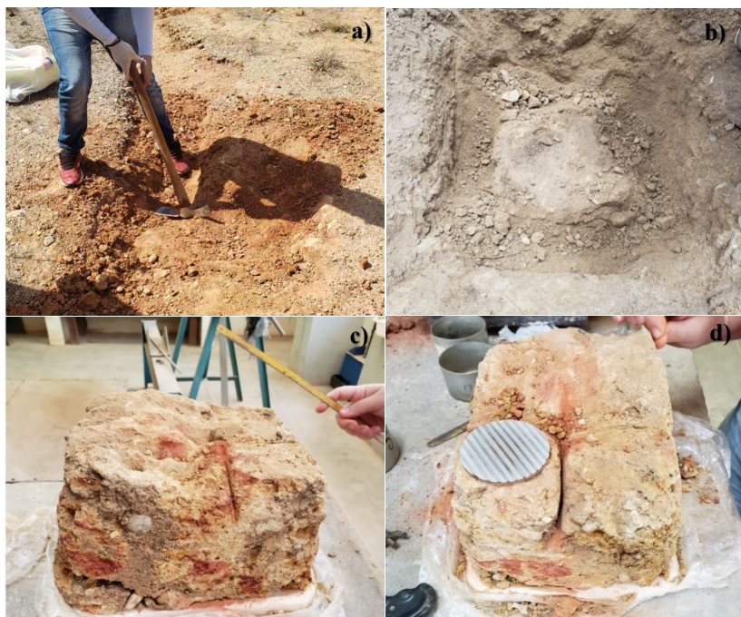
Figura 2 – Coleta (a) e preparo das amostras indeformadas (b, c, d). Fonte: Elaboradas pelos autores (2024).
