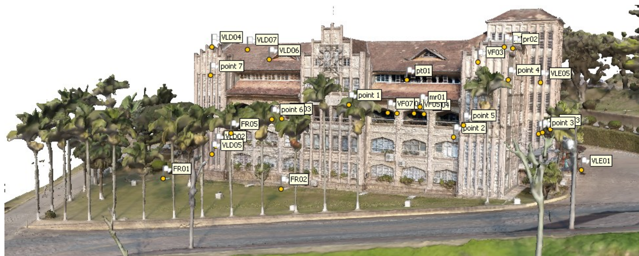
Figura 2 – Modelo digital de referência do edifício Hansahoehe e pontos de controles e de chegada.
