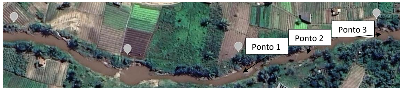
Figura 4 – Disposição espacial dos pontos de análise da condutividade hidráulica vertical do leito do rio. Fonte: Autores (2025).
