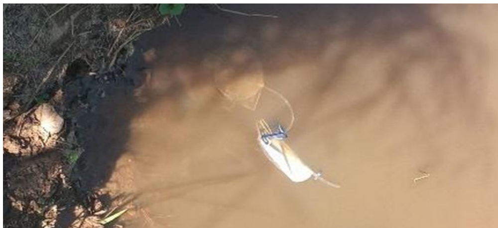
Figura 3 – Estimativa de condutividade hidráulica vertical de leito de rio, por meio de cilindro. Fonte: Autores (2025).
