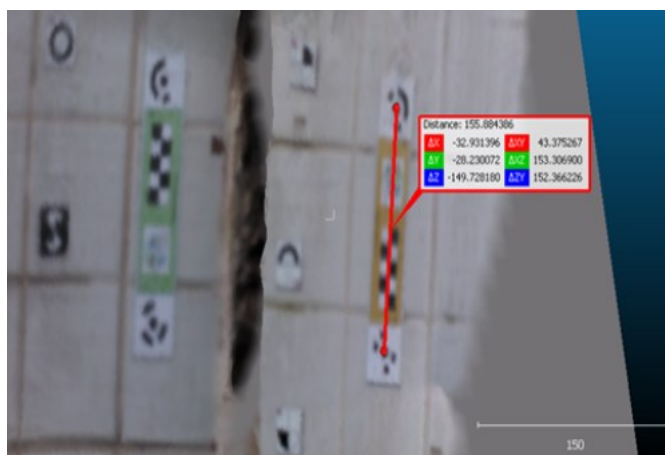
Figura 7 – Medição das distâncias de referência por luz estruturada. Fonte: Os autores (2026).
