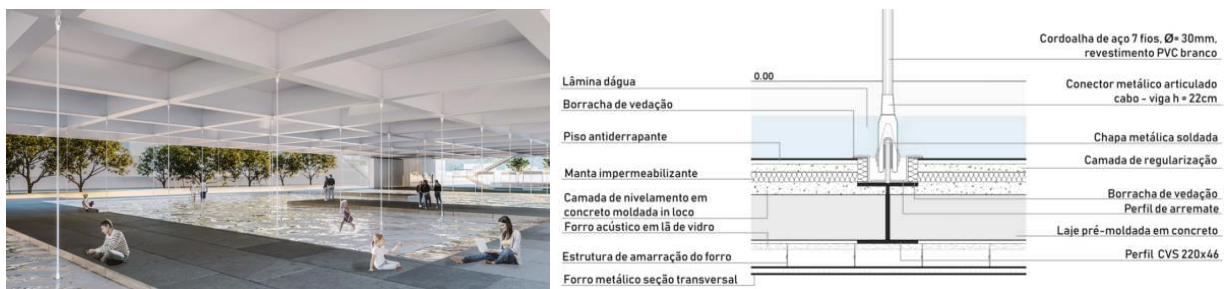
Figura 3: Vista geral do espelho d'água e detalhe de seus tirantes de sustentação.
