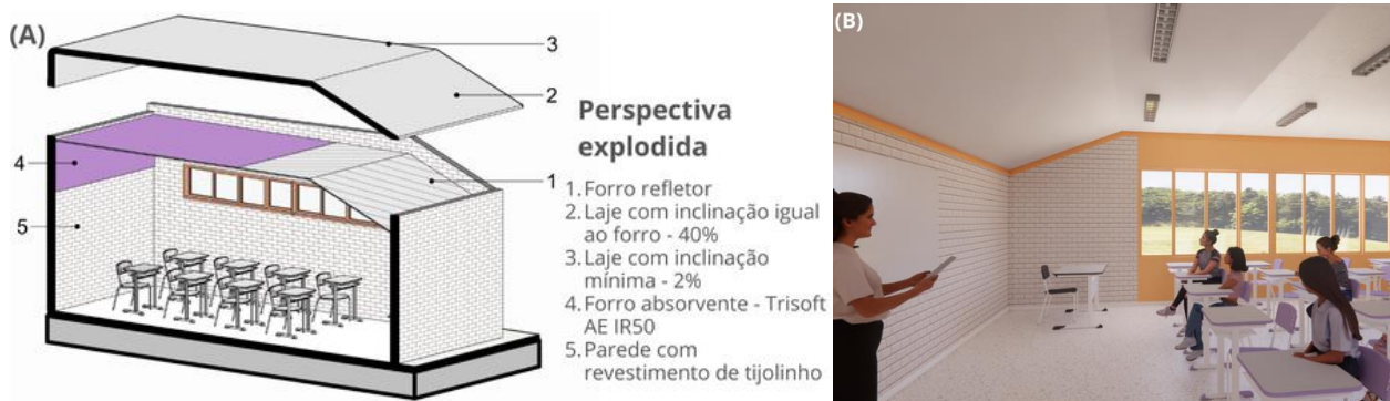
Figura 08: Sala de Aula padrão da escola Harmonia: (A) Perspectiva Explodida com indicação de materiais (B) Perspectiva fotográfica.
