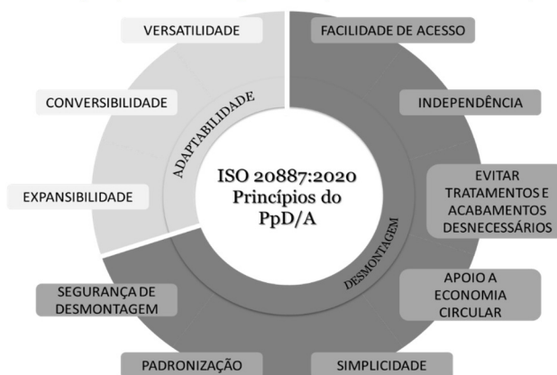
Figura 1: Princípios de Projeto para Desmontagem e Adaptabilidade determinados pela ISO 20887/2020
