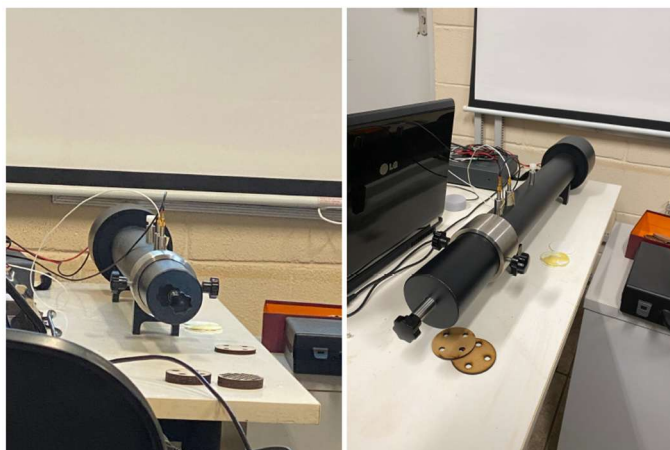
Figura 6: Tubo de impedância utilizado nos testes.
