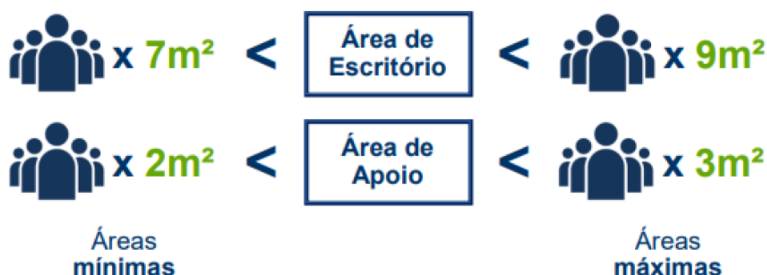
Figura 03- Metragens Mínimas para Dimensionamento de Ambientes
