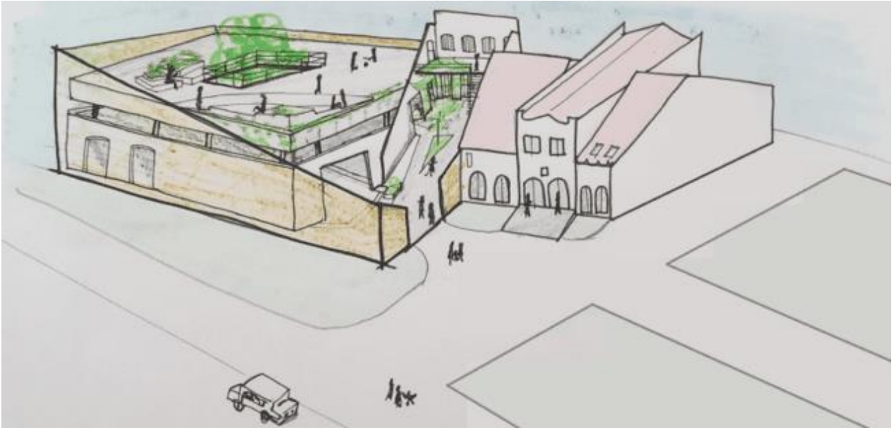
Figura 11: Croqui da volumetria geral com criação de novo acesso principal pela praça, guiado pela fachada-pele. Notar o mezanino-mirante e o acesso do restaurante-escola, no fundo dos sobrados.
