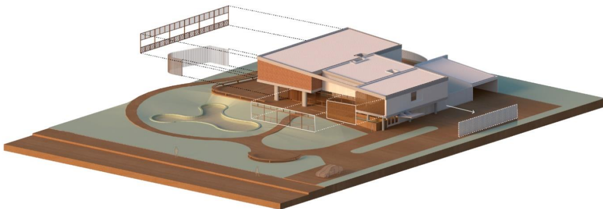
Figura 15: Diagrama isométrico da relação elementos de vedação/ estrutura formal arquitetônica.
