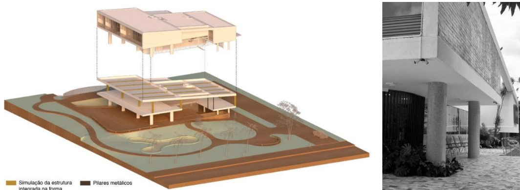
Figura 09: Estrutura da Residência Cassiano Ribeiro Coutinho.
