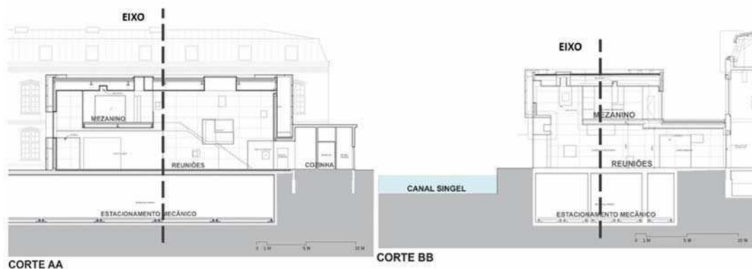
Figura 11: Análise do corte esquemático transversal e longitudinal do projeto de Sarphatistraat.
