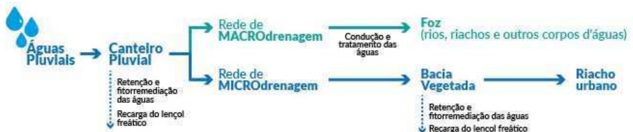
Figura 9: Esquema da rede de microdrenagem proposta.
