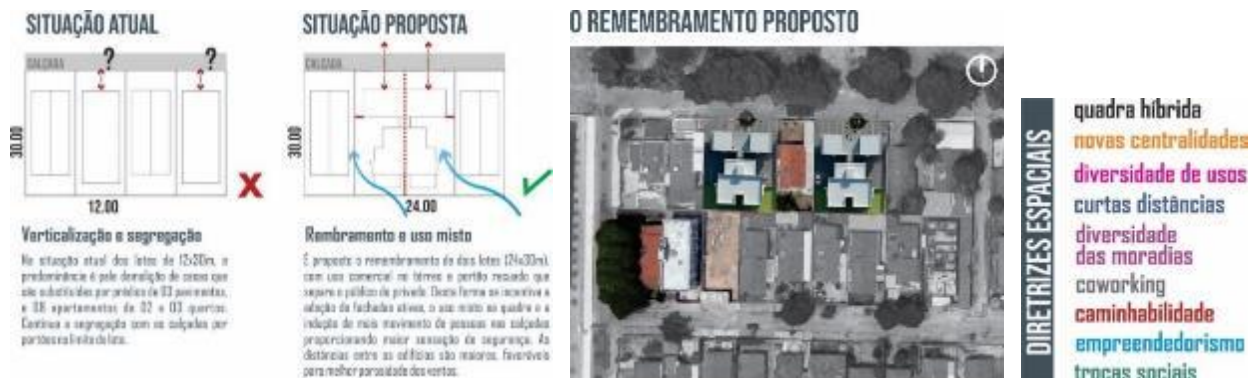
Figuras 15 e 16: Proposta do remembramento gradual de dois lotes de 12x30 e diretrizes.
