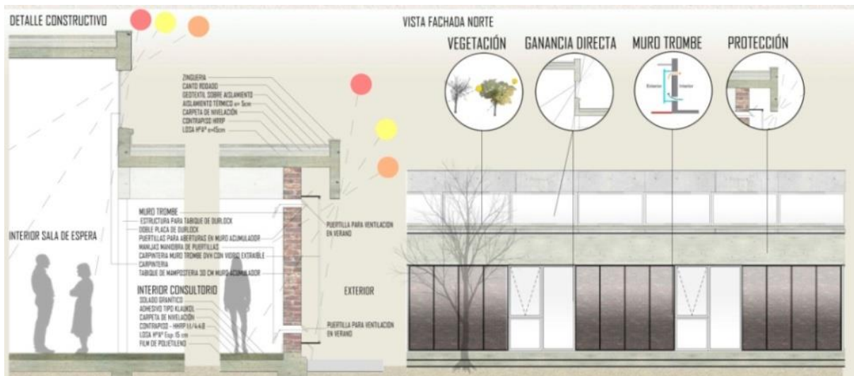
Imagem 12: Detalhe da Fachada
