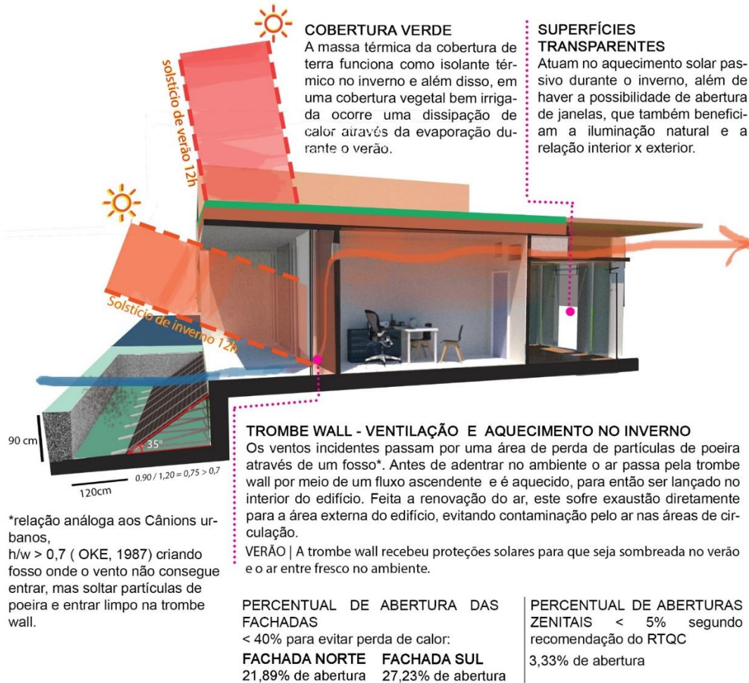
Figura 6: Corte Transversal – Demonstração de funcionamento dos sistemas
