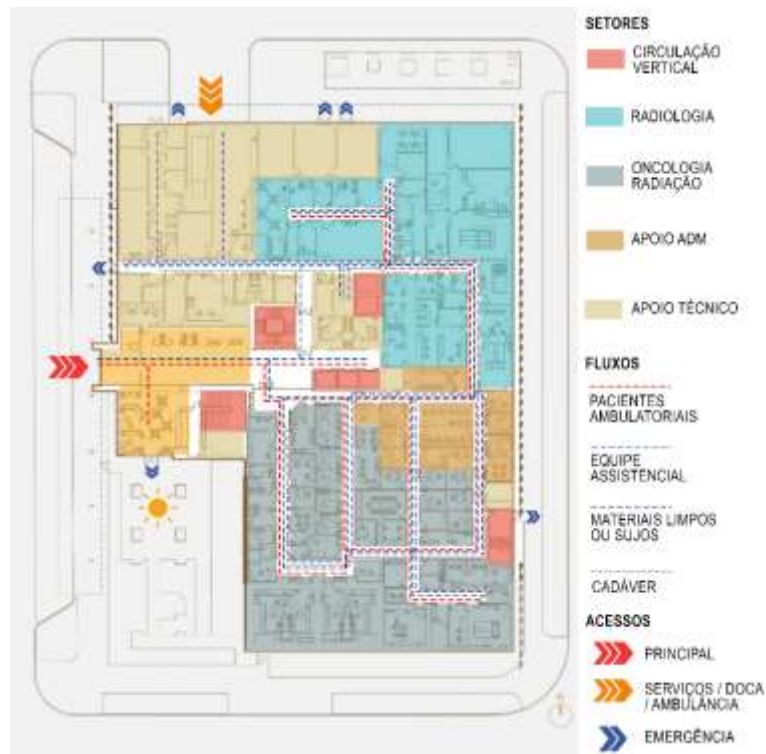
Figura 7: Planta do pavimento térreo
