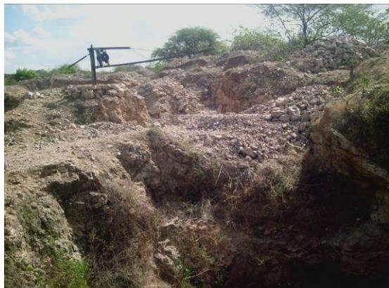
**Figura 7 - Esvaziamento do túnel de jazida, rejeitos jogados no solo de forma inadequada**
